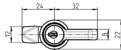
Ручка-бабочка с корпусом, отлитым из цинка; отлитый из цинка цилиндр с колпачком из нержавеющей стали; гайка, также заземляющая, с болтом из оцинкованной стали
