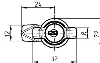
Ручка-бабочка с корпусом, отлитым из цинка; отлитый из цинка цилиндр с колпачком из нержавеющей стали; гайка, также заземляющая, с болтом из оцинкованной стали
