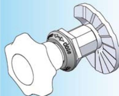
Корпус с упором при повороте на 270°
