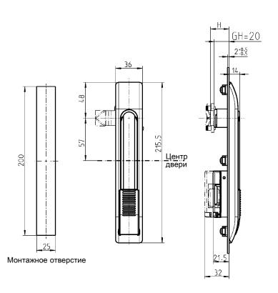
Откидная ручка из черного полиамида PA-GF с нажимной кнопкой (2100-U57) Ручка из цинка ЛПД с черным напылением, шарнирный стержень из цинка ЛПД (оц.) крепеж из оцинкованной стали, крепежный мостик из черного полиамида PA-GF; с уплотнением
