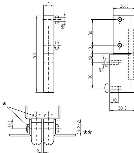
\* \*При 18 мм достигается угол открытия 180° в секционных шкафах с двойными дверями.
