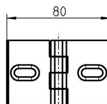
Петля для профильных рельсов: из цинка ЛПД с черным напылением, штифт из нержавеющей стали, пазовые сухари из цинка ЛПД
