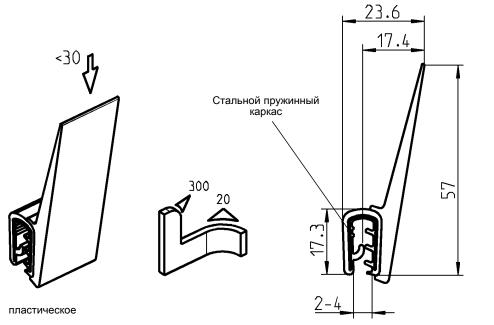
Уплотнительный профиль из губчатой резины ЭПДМ черн. (зажимной профиль ПХВ 70° ± 5 Shore A)
